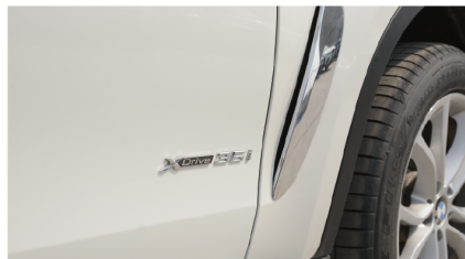
- 侧面引流槽，梳理车身空气流动，增加高速行驶的稳定性和下压力
